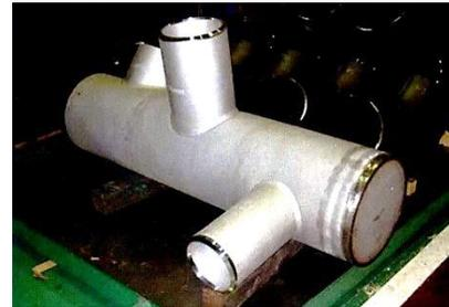
溶接式管継手と大径溶接鋼管との組立溶接を主に、容器類やヘッダー等の組立品の製作可能です
